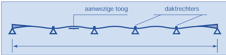
Afbeelding 30. Opvullen buitenste rand ten behoeve van een goed dakafschot.
